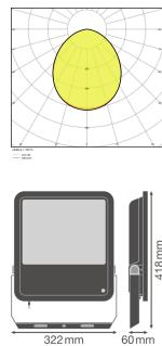
**Technische Daten Ledvance LED-Scheinwerfer Photocell GEN 3 Schwarz 165W 20000lm 100D - 840 | IP65 - Lichtsensor - Symmetrisch**
