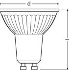
**Technische Daten Osram Parathom LED-Spot GU10 PAR16 6.9W 575lm 36D - 840 | Ersatz für 80W**
