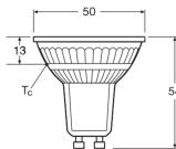
**Technische Daten Osram LED Superstar Reflektor Spot GU10 PAR16 4.7W 350lm 36D - 940 | Höchste Farbwiedergabe - Dimmbar - Ersatz Für 50W**
