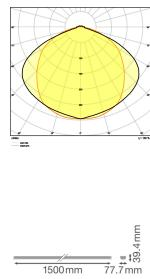
**Technische Daten Ledvance LED Tragschiene Trusys Flex Klar Stahl Weiß 35W 6000lm 120D - 840 Kaltweiß | 3 Stunden Notbeleuchtung**
