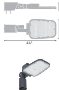
**Technische Daten Ledvance LED-Straßenbeleuchtung Area Value klein SPD Aluminium Grau 30W 4050lm 160x58D - 740 | IP66 - Symmetrisch**
