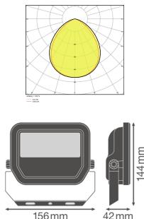
Caractéristiques Ledvance Projecteur LED GEN 3 Noir 20W 2400lm 100D - 865 | IP65 - Symétrique - Remplacement 50W
