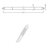
Caractéristiques Ledvance Tube LED T5 Value Short (HF) High Efficiency 7W 770lm - 830 | 52cm - Remplacement 13W
