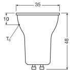
**Caractéristiques Osram LED Superstar Réflecteur Spot GU10 PAR16 3W 230lm 36D - 827 | Dimmable - Remplacement 35W**
